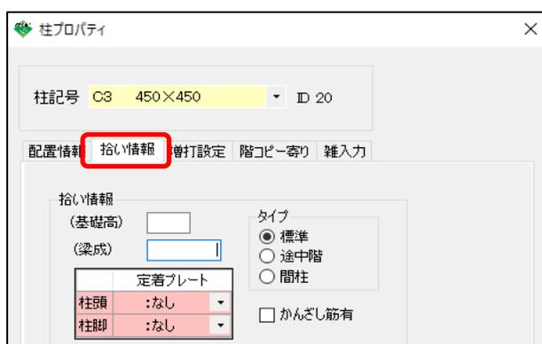
2.タイプを「途中階」に設定し、主筋の下定着させたい長さを「基礎高」に入力します。
