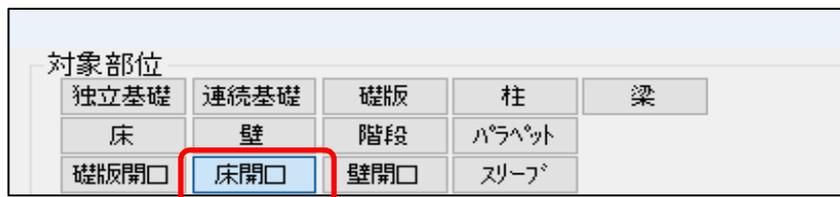
2. 床開口プロパティが表示されるので、ここで開口補強筋を入力します。
