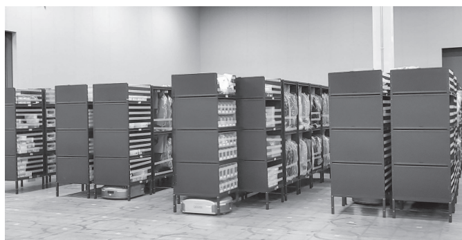
搬送ロボットが最適な保管棚を選んでスタッフの前まで運ぶ
